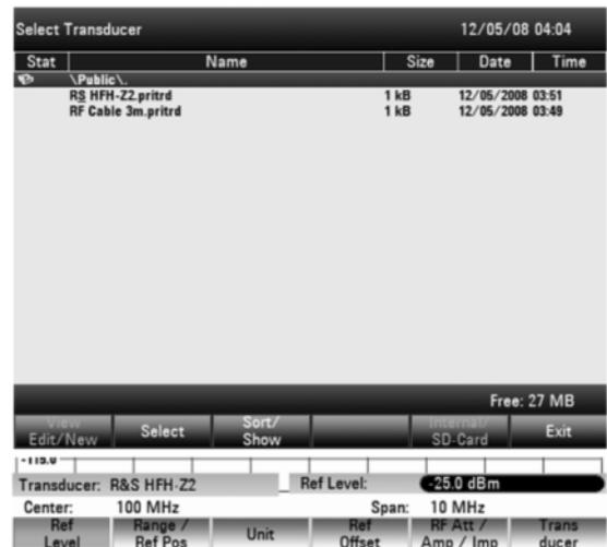
Выбранный коэффициент преобразования отобразится в дополнении к полю ввода опорного уровня.
