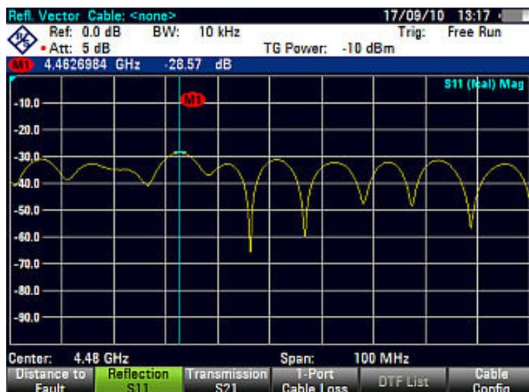
Рисунок 8.5 – Результаты измерения потерь на отражение
