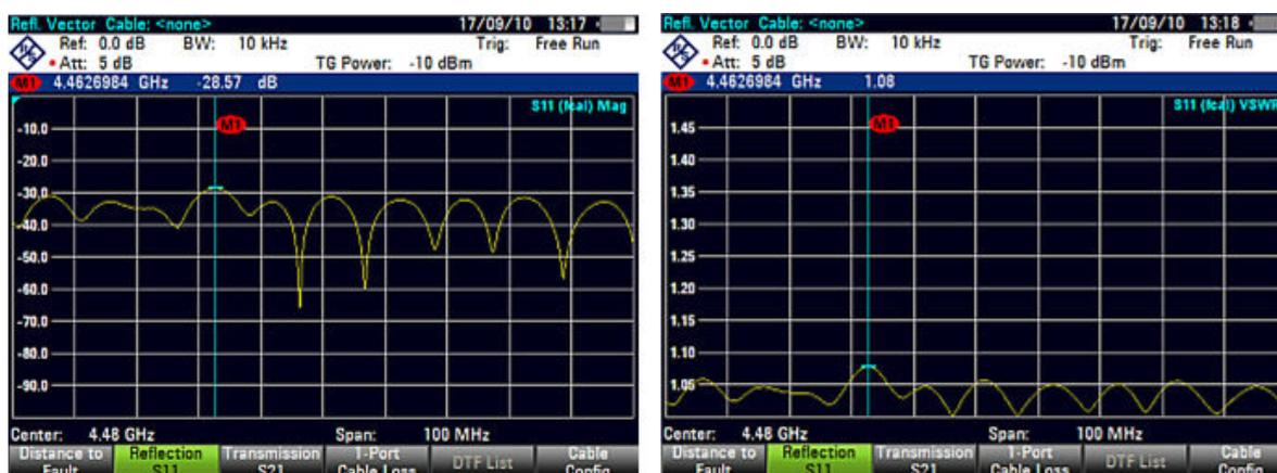
Рисунок 8.9 – Результаты измерений в формате модуля и КСВН
