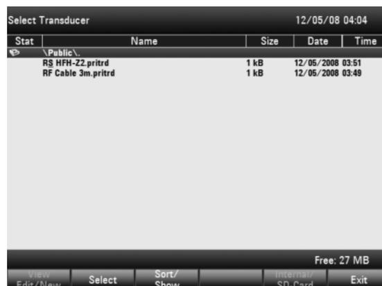
Примечание – При вставленной SD-карте переключение между внутренней памятью и памятью карты производится нажатием функциональной клавиши INTERNAL/SD-CARD.
