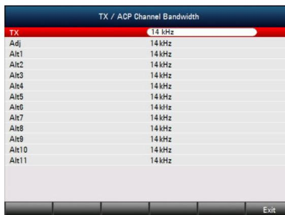
Анализатор R&S ZVH автоматически устанавливает нужный диапазон для полосы канала в соответствии с критерием, описанным выше, чтобы гарантировать правильное измерение мощности в канале.
