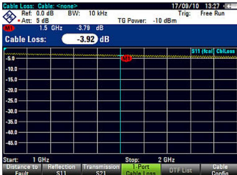
Рисунок 8.7 – Результаты измерения потерь в кабеле
