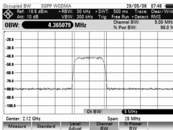
Для введенной полосы частот канала будет автоматически установлена подходящая полоса обзора (полоса обзора = 5 x полоса частот канала) чтобы гарантировать правильное измерение занимаемой полосы частот. Минимальная полоса частот канала может быть установлена равной 2 кГц.
