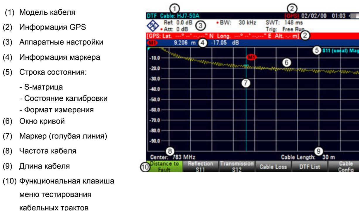
Рисунок 8.4 – Вид экрана анализатора кабельных трактов и антенн.
