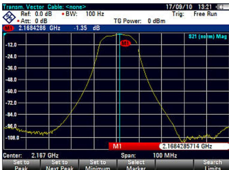
Рисунок 8.8 – Результаты измерения коэффициента прямой передачи фильтра
