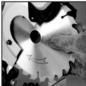
Открутите рычаг зажимного кожуха и снимите его. Ослабьте винт крепления кожуха и откиньте его наверх. Теперь у вас есть доступ к замене пильного диска.
