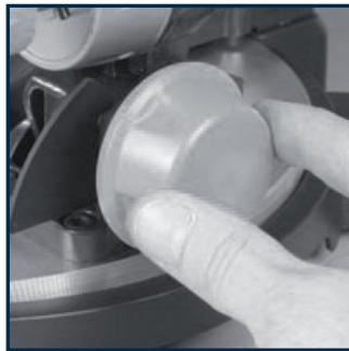
Ослабьте винт блокировки угла наклона пилы. Установите пильную головку под нужным вам углом. Затяните винт блокировки. Угол наклона пилы регулируется от 0° до 45° влево.
