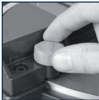
Ослабьте винт блокировки поворотного стола. Установите поворотный стол под нужным вам углом. Затяните винт блокировки. Поворотный стол может регулироваться на угол от 0° до 45° влево и вправо и имеет предустановки с защёлками в позициях 0°, 15°, 22,5°, 30° и 45° для быстрой настройки.
