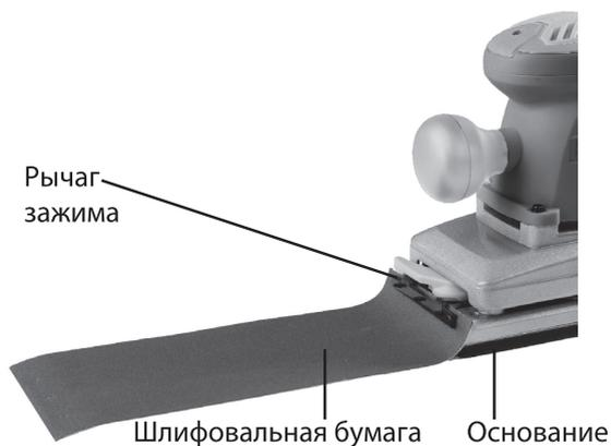
Поверните рычаг зажима против часовой стрелки. Вставьте конец бумаги в зажим, выровняйте шлифовальную бумагу по основанию. Закройте зажим по часовой стрелке.
