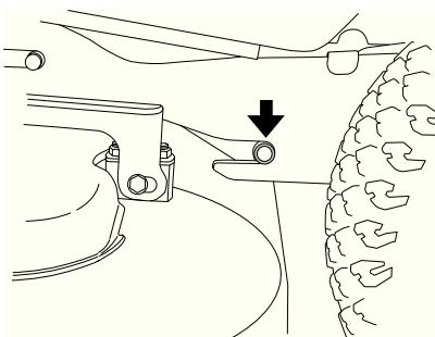
8 Установите приводной ремень на ведущие колеса режущего блока. Убедитесь, что ремень правильно установлен в шкиве натяжителя ремня.
