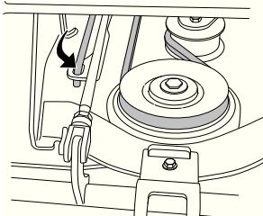
10 Закрепите прижимную пружину.
