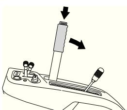
Этот рычаг можно также использовать для временного регулирования высоты резки, например на небольшом бугре на газоне.
