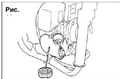
1. С помощью небольшого проволочного крючка извлеките бензопровод и фильтр из бака.
