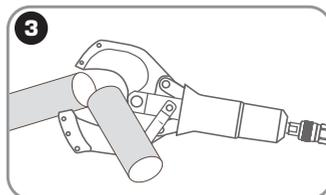
**Создайте давление помпой, разрежьте кабель. Сбросьте давление до полного возврата лезвий**
