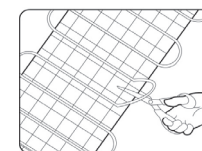
Разрезайте только ткань. НО НЕ ПРОВОД!
