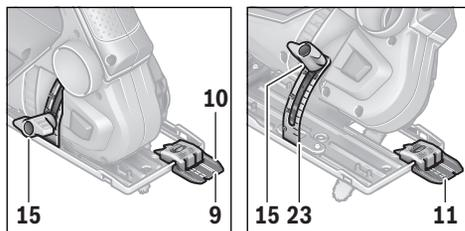
Za kontrolu linije rezanja na kontrolnom prozorčiću za »Cut Control« postoji oznaka **9** za pravokutno rezanje sa 0° i oznaka **11** za koso rezanje ulijevo sa 45°. Na skali **23** ćete pronaći oznake za 22,5, 30 i 45°. Mogući su međurezovi.
