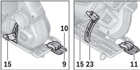
Lõikejoone kontrolliks on „Cut Control“ vaateaknal **9** märgis paremale poole kulgeva lõike jaoks tähisega 0° ja **11** märgis vasakule poole kulgeva kaldlõike jaoks tähisega 45°. Skaalal **23** on märgised 22,5, 30 ja 45°. Võimalikud on vahelõiked. Vahemikku 0° kuni 45° jäävate lõikenurkade jaoks tuleneb lõikemärk proportsionaalselt. Selle saab mittepüsiva markeriga kanda lisaks aknale „Cut Control“ ja kergesti uuesti eemaldada.
