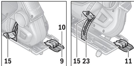
За контрол на линията на среза на прозорчето на системата „Cut Control“ има маркировка **9** за срезове под прав ъгъл, означена с  $0^\circ$ , и маркировка **11** за срезове под наклон наляво, означена с  $45^\circ$ . На скалата **23** можете да намерите маркировките за  $22,5$ ,  $30$  и  $45^\circ$ . Възможни са и междинни стойности.
