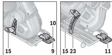
Для контроля линии распила на смотровом окошке «Cut Control» есть метка **9** для распила под прямым углом 0° и метка **11** для распиливания под левым углом 45°. На шкале **23** имеются метки 22,5, 30 и 45°. Возможно пиление под промежуточными углами.
