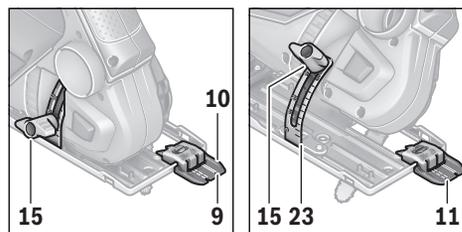
Lai atvieglotu instrumenta vadīšanu pa zāģējuma trasi, zāģējuma trases kontroles ierīces „Cut Control“ marķieris satur marķējumu **9** zāģēšanai ar taisnu leņķi 0° un marķējumu **11** zāģēšanai ar 45° nolieci pa kreisi. Uz skalas **23** ir iedaļas zāģēšanas leņķa vērtībām 22, 5, 30 un 45°. Zāģēšana ir iespējama arī pie leņķa starpvērtībām.
