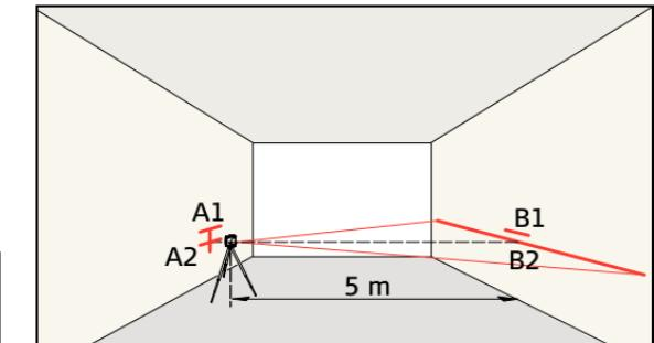
Затем поместите прибор на той же высоте как можно ближе к стене А и снова отметьте горизонтальную линию лазера или лазерную точку на стене А (-> A2). Разверните прибор на 180 градусов снова и сделайте отметку на стене В (-> B2). Измерьте расстояние между отмеченными точками A1-A2 и B1-B2. Подсчитайте разницу между двумя замерами. Если разница не более 2 мм, значит точность прибора Leica Lino в пределах допустимого.
