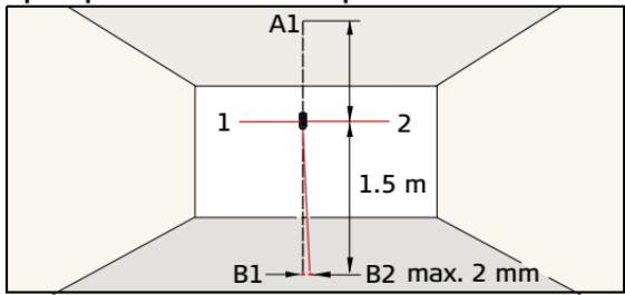
Установите лазер на штатив или на кронштейн для настенного монтажа рядом с точкой А1 на минимальном расстоянии 1.5 м от точки В1. Горизонтальная линия лазера выровнена в направлении 1. Отметьте лазерные точки А1 и В1 маркером.
