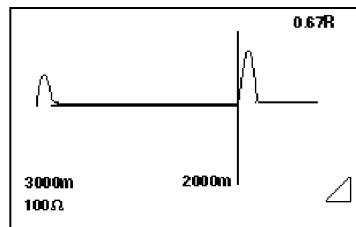
Если не удалось обнаружить отраженный сигнал, воспользуйтесь регулятором «TX Null» для уменьшения влияния входного импульса в случае, если дефект расположен близко к месту подключения прибора (подробнее см. раздел «TX Null»).
