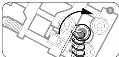
**Вращая инструмент за рукоятку вокруг кабеля по спирали, снимите полупроводящий экран на необходимую длину. В конце движения сделайте оборот перпендикулярно оси кабеля для формирования равномерного среза.**
