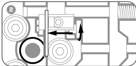
**Вращая регулировочный винт, настройте нож на глубину срезаемого слоя.**
