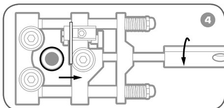
**Вращая рукоятку инструмента, отведите каретку на достаточное расстояние. Аккуратно снимите инструмент с кабеля, оберегая его от случайных повреждений и задиrow поверхности.**
