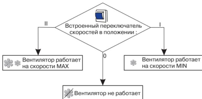
Последовательность подключения к электросети модели базовой модификации, с встроенным переключателем скоростей, без кабеля питания, а также модели с таймером:
