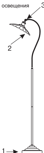
Рис.1, конструкция: 1. Основание 2. Плафон 3. Фиксирующий винт
