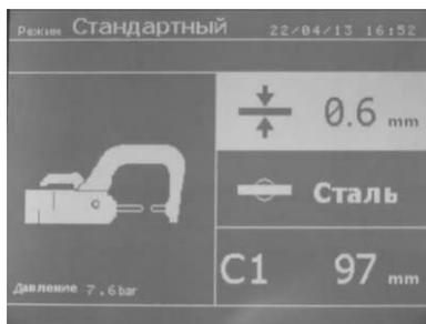
При включении аппарата этот режим устанавливается по умолчанию. Он позволяет очень просто сделать сварную точку, выбрав: - среднюю толщину соединенных листов металла в диапазоне от 0.6 до 3.0 мм с шагом 0.05 мм.
