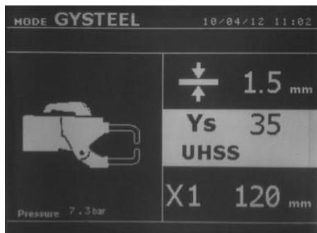
Режим GYSTEEL - такой же как и стандартный режим, за исключением того, что пользователь вводит предел упругости листов. Это Re можно узнать с помощью твердомера.
