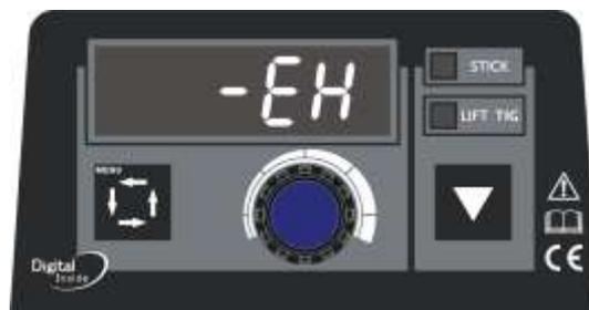
Рис 11: Дисплей при перегреве
