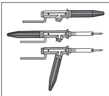
Данный паяльник может конвертироваться из ручки в паяльный пистолет простым прикручиванием рукоятки. Вы также можете использовать рукоятку как защитный чехол паяла и ствола паяльника. Компактная конструкция позволяет при необходимости носить прибор с собой.
