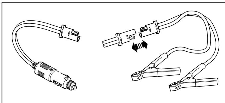
Соединение разъема фонаря с разъемом контактных зажимов/прикуривателя
