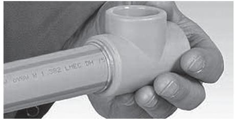
Далее следует подержать соединенные элементы некоторое время, после чего произойдет сопряжение и естественное охлаждение сваренных деталей.
