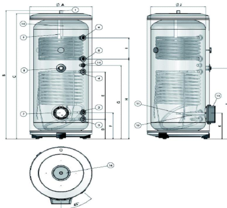
16 Выход горячей воды 1"М
