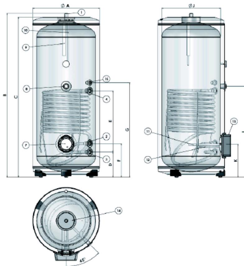
1. Выход горячей воды 1"М
