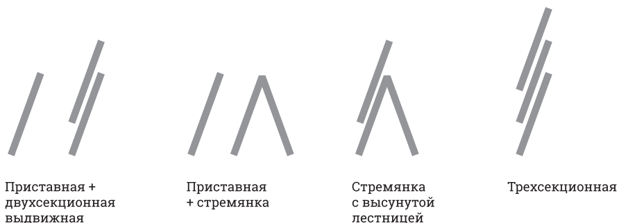
Рис. 1. Возможности использования секций лестницы
