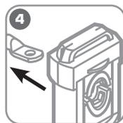
**Сбросьте давление и откройте поворотную крышку. Извлеките опрессованное изделие из зоны опрессовки**
