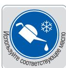
Во время подготовки инструмента к эксплуатации убедитесь, что используемое гидравлическое масло соответствует температуре окружающей среды в месте проведения работы. Проверьте наличие и уровень масла в резервуаре инструмента
