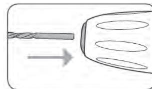
Аккуратно вставьте хвостовик сверла/биты в патрон (1), после чего закрутите патрон (1) по часовой стрелке до полной фиксации.
