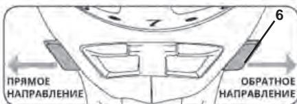
Вращение в обратную сторону также помогает освободить сверло при заклинивании и извлечении сверла из отверстия. Если переключатель (6) установить в центральное положение, выключатель (7) будет жестко зафиксирован и его нельзя будет нажать.
