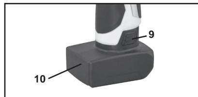
Для этого отсоедините аккумулятор (10) от дрели-шуруповерта путем нажатия фиксаторов аккумулятора (9) и подключите к зарядному устройству соблюдая полярность (-/+). Зарядное устройство подключите к сетевому адаптеру, который в свою очередь подключите к сети. На зарядном устройстве загорается индикатор.
