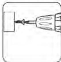
**ВНИМАНИЕ!** Регулятор крутящего момента (2) нужно устанавливать в любое значение, кроме «сверление», в зависимости от размера крепежного материала и типа поверхности.
