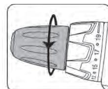
Если хвостовик сверла/биты не входит в патрон (1), то, вращая цилиндрическую часть патрона (1) против часовой стрелки, добейтесь разведения кулачков до нужной степени.
