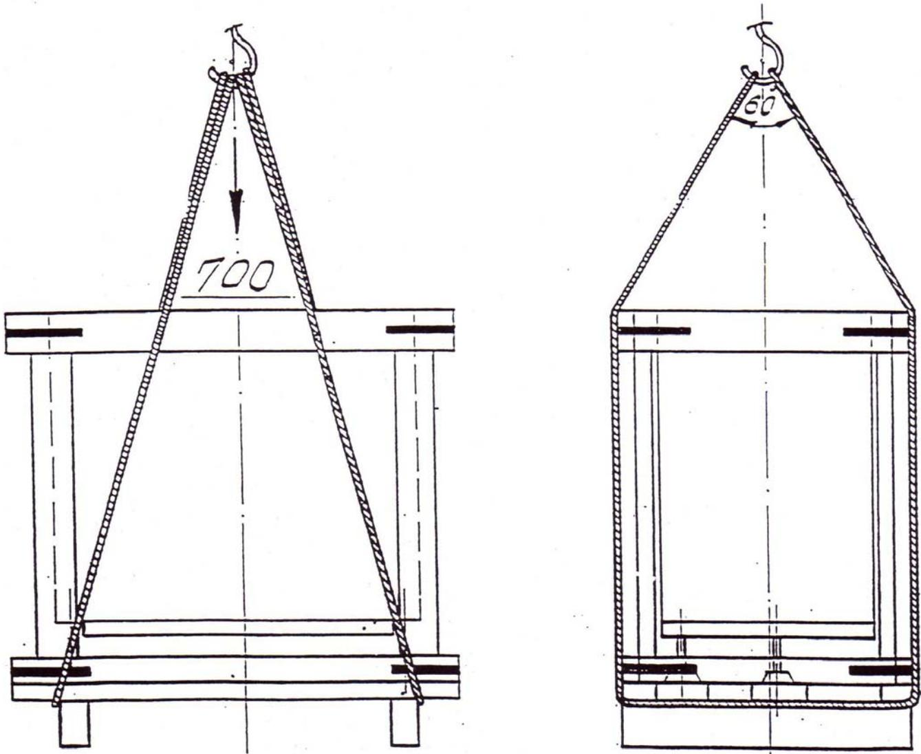
Рис. 11 Схема строповки котла.
