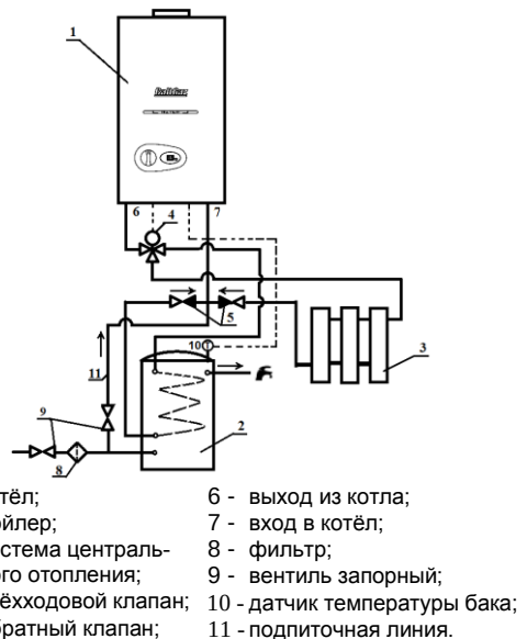
Рис. 8. Схема гидравлического присоединения бойлера
