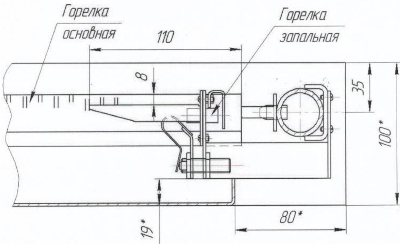
Рис. 2А. Схема расположения горелки запальной относительно основной
