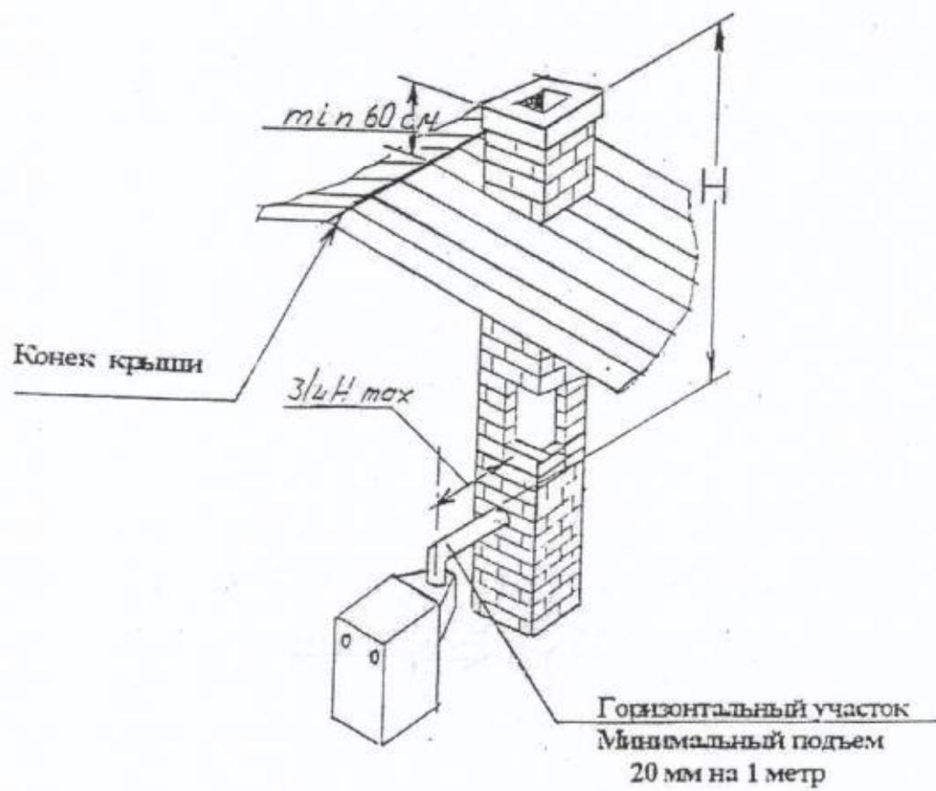
Рис. 7 . Типовой кирпичный дымоход.
