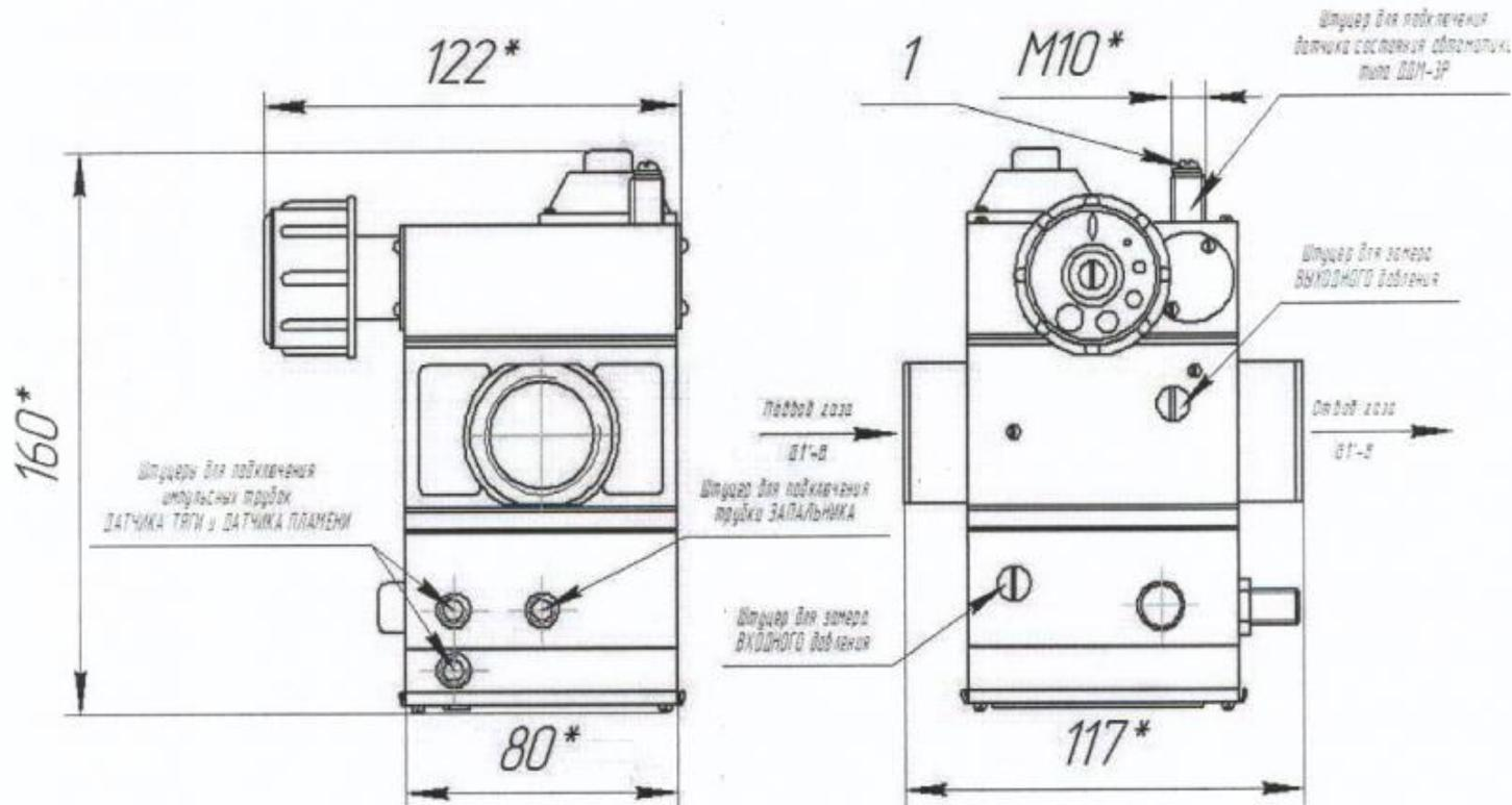
Рис. 2Б. Схема расположения точек подключения блока автоматики.
