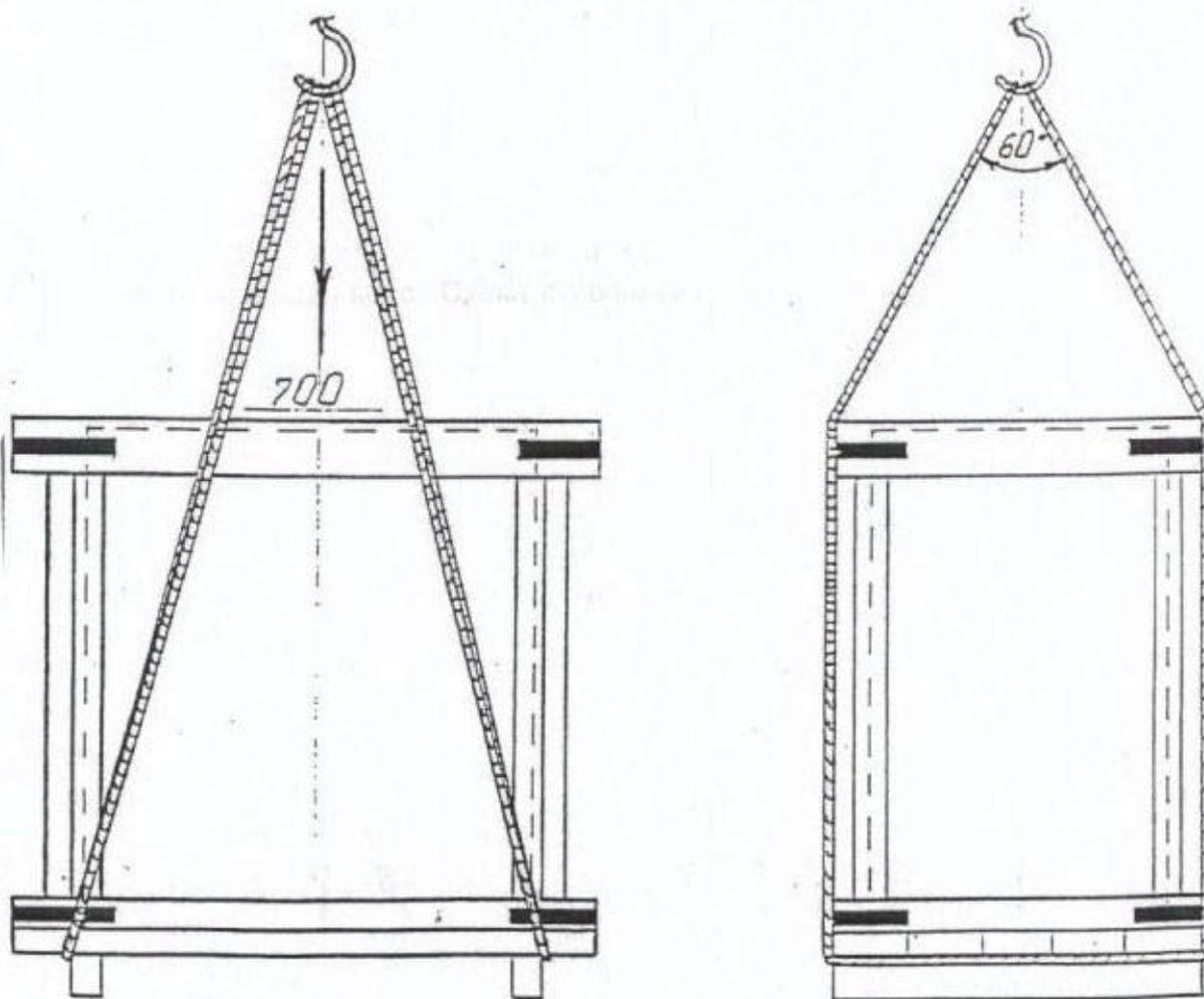
Рис. 8 Схема строповки котла.
