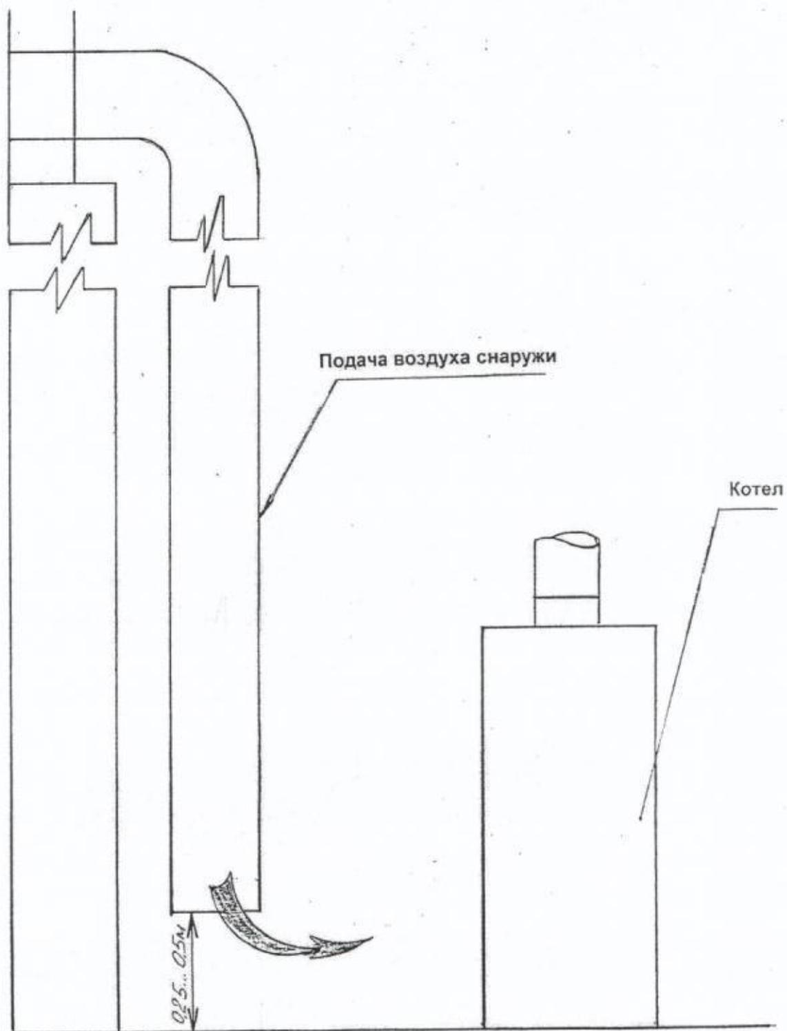
Рис. 6 Подача воздуха в герметично закрытое помещение.
