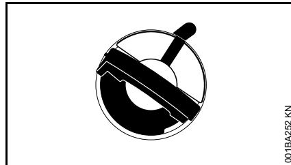
Маркировки на крышке бака и топливном баке должны совпадать
