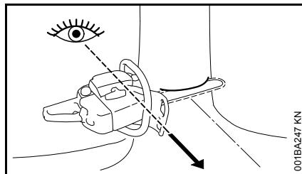
При установке подпила бензопилу следует выровнять таким образом, чтобы подпил располагался в правом углу к направлению валки.
