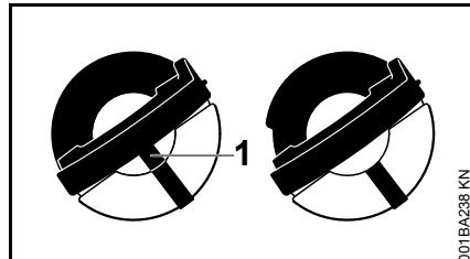
слева: Нижняя часть крышки бака перекручена – расположенная внутри маркировка (1) совпадает с внешней маркировкой
