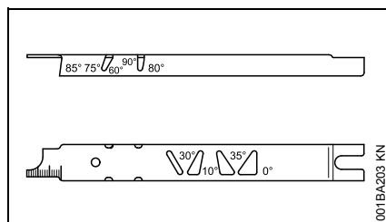
Пользоваться опиловочным шаблоном STIHL (специальные принадлежности, см. таблицу "Инструменты для заточки") – универсальный инструмент для контроля угла заточки и переднего угла, высоты ограничителя глубины, длины зуба, глубины паза и для очистки пазов и впускных масляных отверстий.
