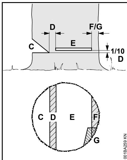
**Подпил (C)** определяет направление валки дерева.
