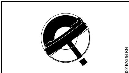
В этом случае будут совпадать маркировки на крышке бака и на топливном баке
