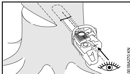
Если возможно, использовать прорезную планку. Прорезная планка и верхняя и нижняя стороны направляющей шины параллельны.
