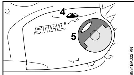
При установке крышки цепной звёздочки зубья натяжной звёздочки и зажимного диска должны зацепляться друг с другом, при необходимости,
