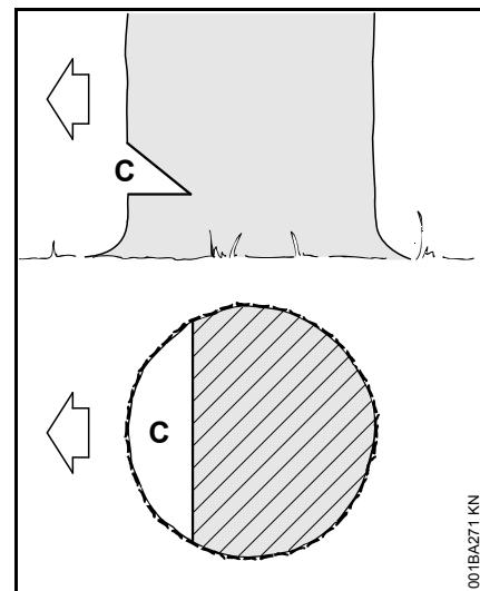
Подпил (С) определяет направление валки дерева.
