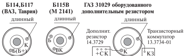
Рис. 2 - Подключение к карбюраторному двигателю
