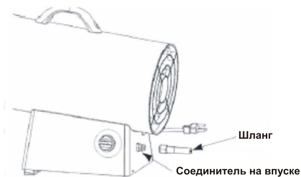
Рис 4. Подключение шланга к выпуску тепловой пушки
