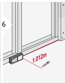
Медленно перемещайте прибор вдоль линии провешивания. На дисплее отобразится расстояние до следующей точки провешивания.
