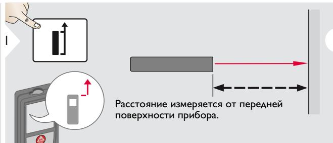
Расстояние измеряется от передней поверхности прибора.
