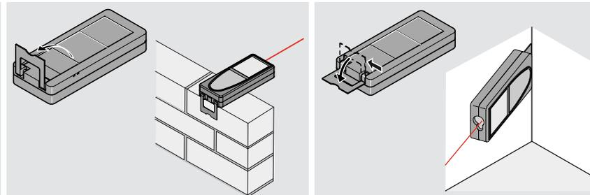
**i** Направление позиционной скобы определяется автоматически и соответственно регулируется начало отсчета.
