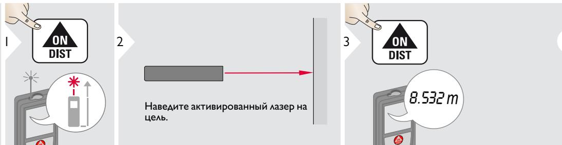
**i** Целевые поверхности: Ошибки при измерениях могут возникнуть в случае выполнения измерений на таких поверхностях, как бесцветные жидкости, стекло, стиролом, матовые полупрозрачные поверхности или при наведении на очень блестящие поверхности. При наведении на темные поверхности время измерения увеличивается.
