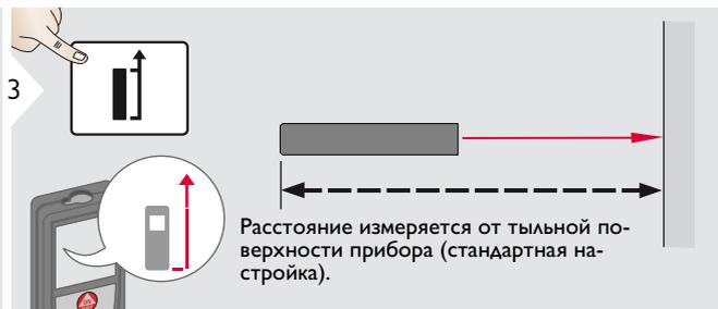
Расстояние измеряется от тыльной поверхности прибора (стандартная настройка).
