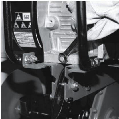
Открутите болт сливного отверстия и крышку маслозаливной горловины. Слейте отработанное масло.
