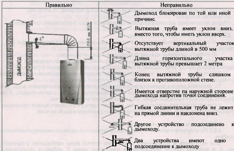
Рис. 5 Подсоединение вытяжной трубы к аппарату
