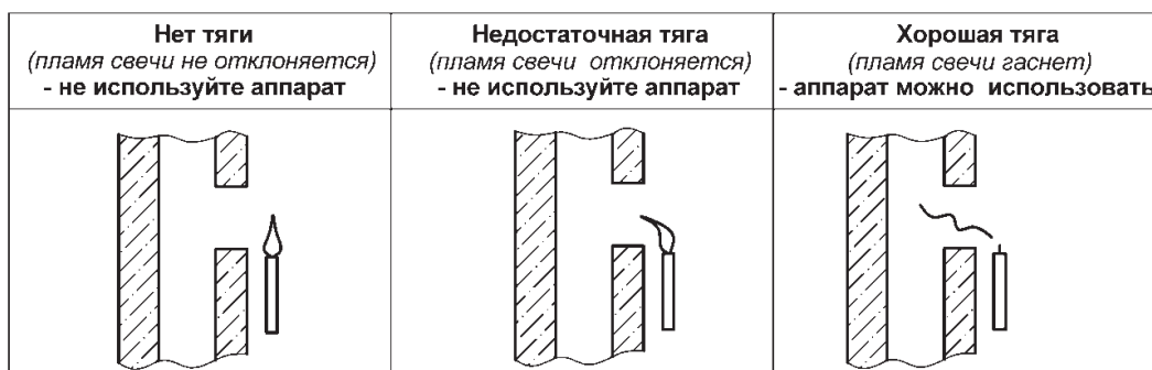
Рис. 4. Способ проверки тяги в дымоходе
