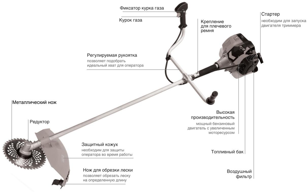
КОНСТРУКЦИЯ И ВНЕШНИЙ ВИД ТРИММЕРА МОГУТ ОТЛИЧАТЬСЯ ОТ ПРИВЕДЕННОЙ В ИНСТРУКЦИИ
