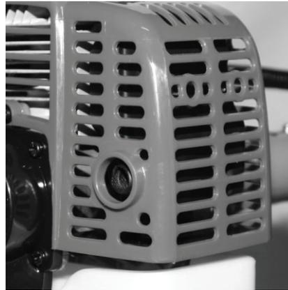
В зависимости от использования триммера необходимо чистить искрогаситель двигателя. Загрязненный искрогаситель может отрицательно сказаться на мощности двигателя и качестве покоса.
