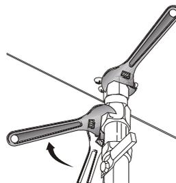
При одновременном монтаже труб установите диэлектрические фланцы на входе/выходе отопления (или на входе/выходе горячей воды)
