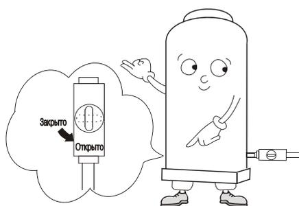
Проверьте открыт ли распределительный клапан, подсоединенный к котлу (в модели GTG отсутствует)
