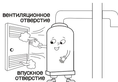
Обязательно установите впускное и вентиляционное отверстия.
