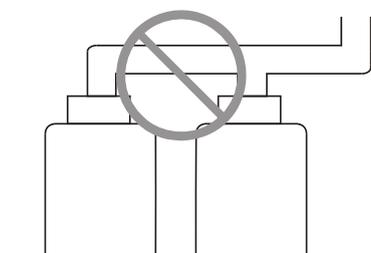
Прямая часть дымоотводящей трубы должна быть наклонена под углом  $5^\circ$  во избежание попадания конденсата или дождевой воды обратно в котел. Обратное попадание конденсата или дождевой воды в котел может снизить эффективность работы и сократить срок службы.
