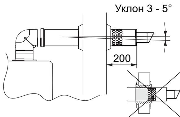
4. Конечный участок дымоотводящей трубы должен располагаться на расстоянии не менее 600 мм от окон, дверей и вентиляционных отверстий.
