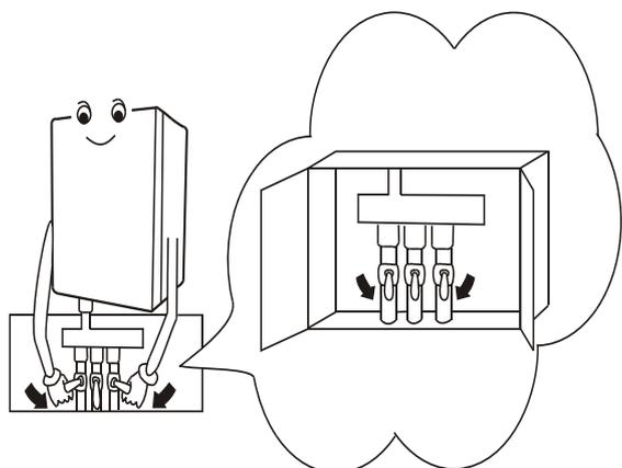
**Проверьте положение газового крана.** Убедитесь в том, что кран перекрывающий подачу газа в котёл открыт.
