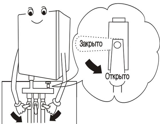
**4. Заполнение котла и системы отопления водой.**
