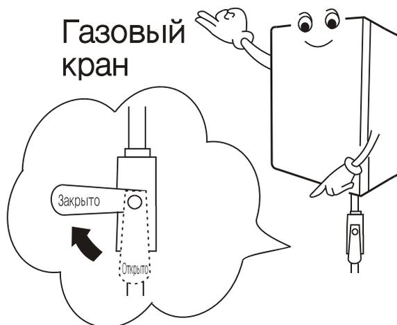
**3. Проверьте положение запорных и распределительных кранов в системе отопления.**
