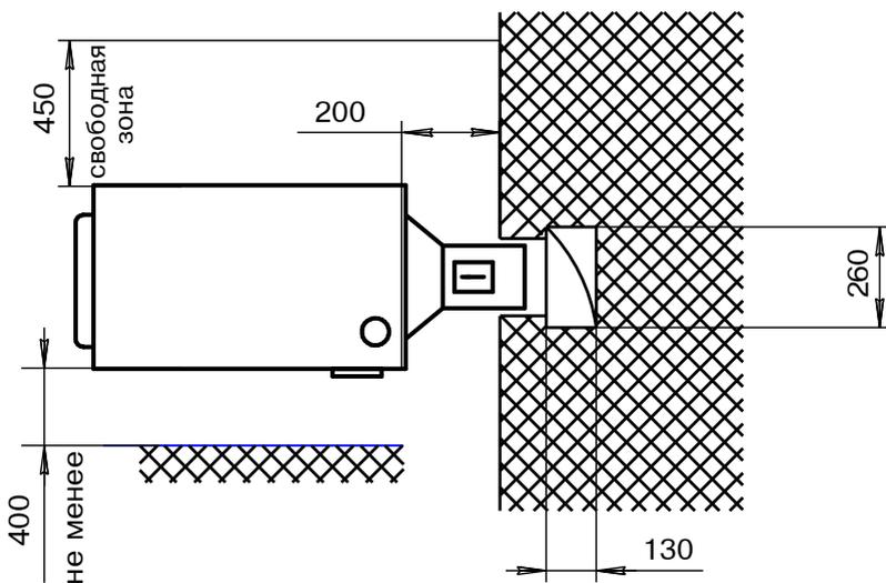
**Рис.2 Схема установки котла**
