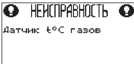
чинает плавно снижать обороты для предотвращения дальнейшего повышения температуры. В случае повреждения датчика температуры газов или отключения его от пульта управления на дисплее появится сообщение о неисправности и отключаются вентиляторы наддува.
