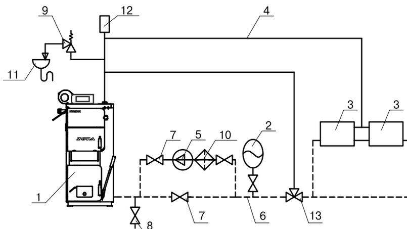
**Рис.8 Схема закрытой системы отопления.
