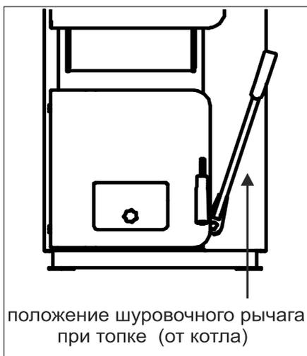
**Рис. 10 Установка рычага шуровочного механизма**
