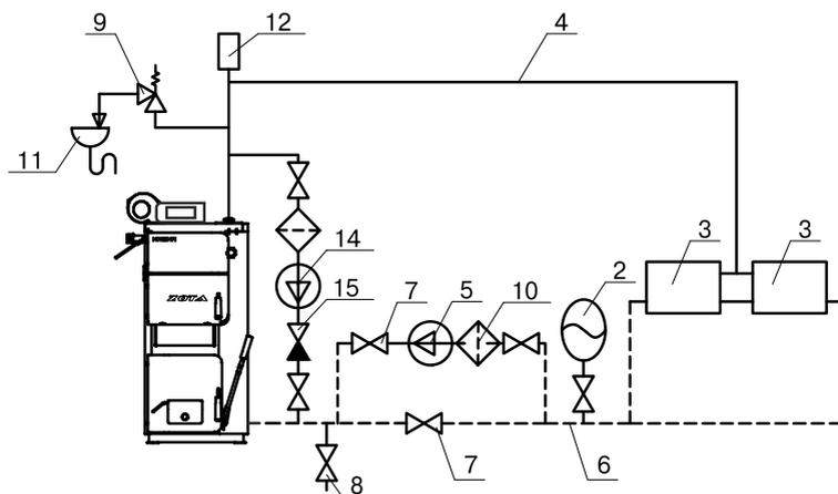
**Рис.7 Схема закрытой системы отопления
