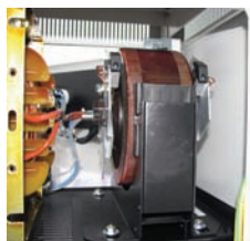
Oberon Y45-15: тороидальный вариатор с двухсторонними токосъемниками
