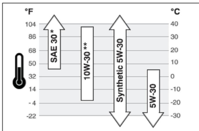
\*При температуре воздуха ниже 4°C использование масла SAE 30 приведет к трудностям при запуске.
