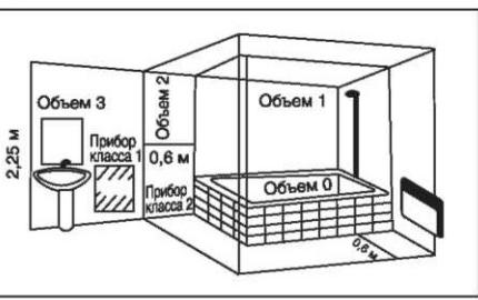
Объем защиты Этот прибор может быть установлен в объеме 2 или 3 при условии, что электрическое питание будет защищено устройством защитного отключения (УЗО), равным 30 мА.
