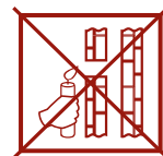
недостаточная тяга (Не используйте котел!)
