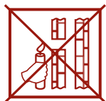
слабая тяга (Не используйте котел!)
