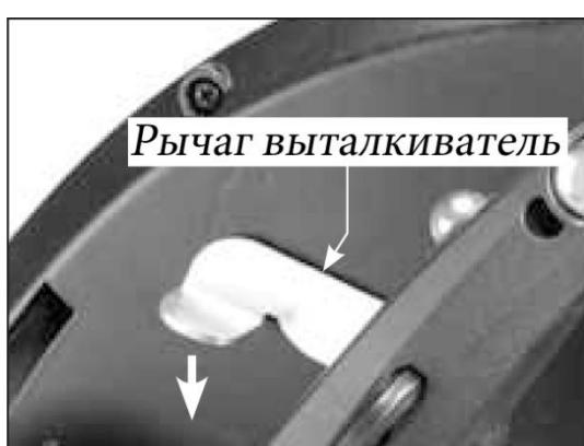
**Выталкиватель:** при резке мягких материалов, таких как сэндвич панели, подвижный кожух может упираться в мягкую часть и не открываться автоматически. В такой ситуации используйте рычаг выталкивателя- он откроет кожух на столько что бы тот продолжил работу в нормальном режиме.
