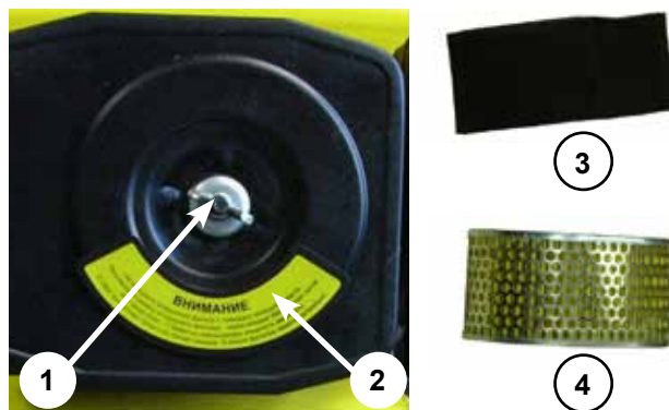
1.Барашковая гайка 2. Крышка фильтра 3. Поролоновый фильтр 4.Бумажный фильтр Рис.19
