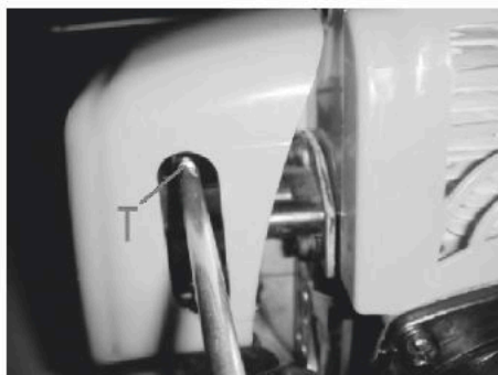
T = Винт регулировки холостого хода
