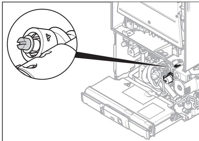
3. Отрегулируйте давление регулировочным винтом (1).
