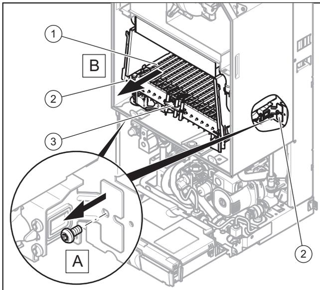
2. Открутите винты на газораспределительной трубе (2).
