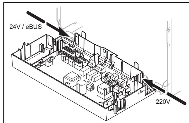
1. Проведите соединительные провода подсоединяемых компонентов через кабельный ввод слева через нижнюю сторону изделия.
