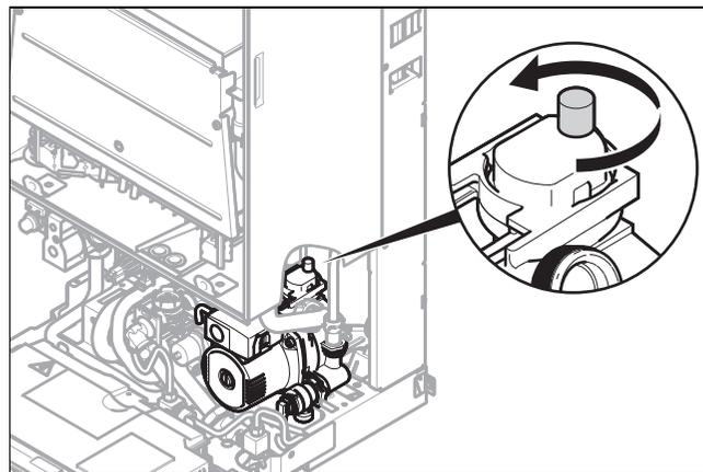
4. Снимите колпачок быстродействующего воздухоотводчика.
