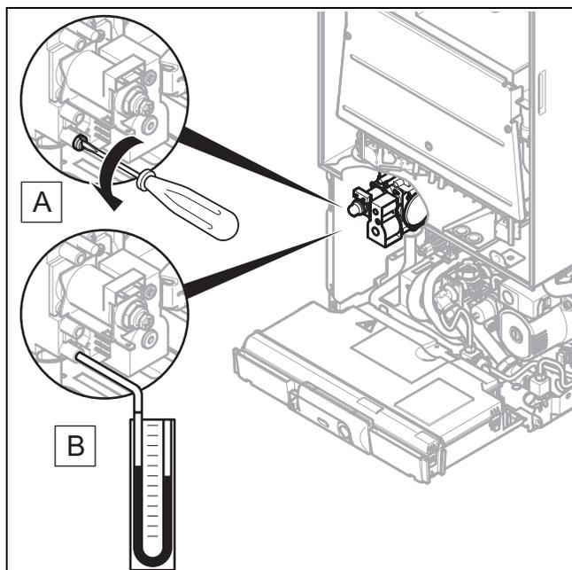
3. С помощью отвертки выкрутите уплотнительный винт из отверстия для измерительного прибора газовой арматуры.
