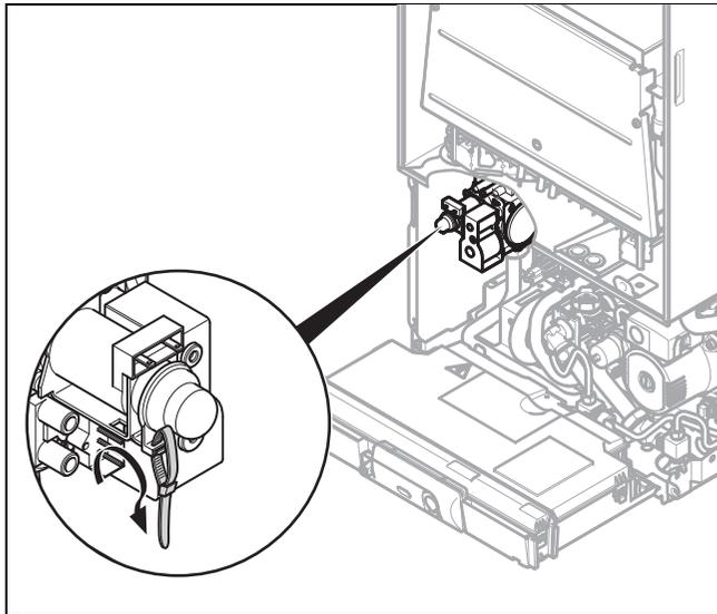
13. Зафиксируйте крышку вентиля кабельной стяжкой или лаком.
