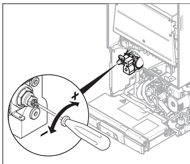
9. Настройте минимальную тепловую нагрузку с помощью гаечного ключа.
