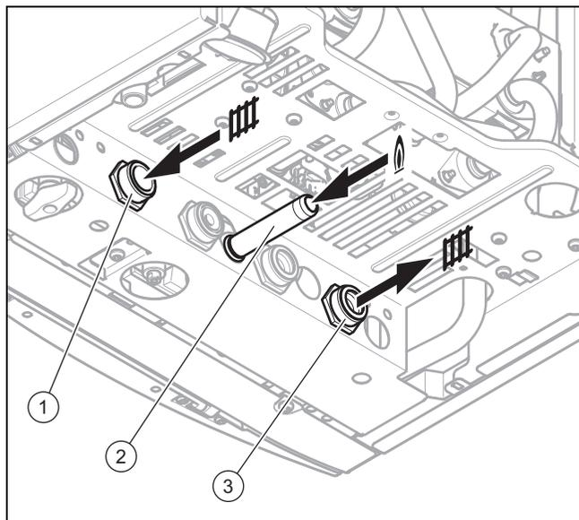
1. Выполните монтаж газопровода с помощью прилагаемого запорного крана к газовому штуцеру(2) без механических напряжений.
