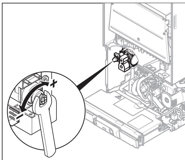
10. Настройте максимальную тепловую нагрузку с помощью гаечного ключа.
