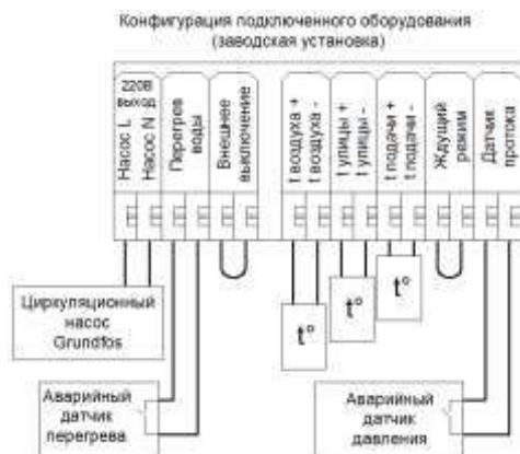
Рисунок 6. Колодка подключения внешнего оборудования
