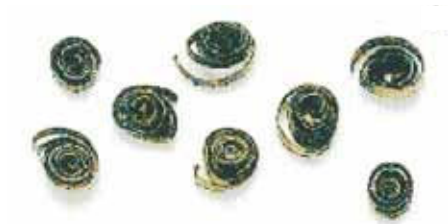
Толстая, тяжелая, с голубым отливом стружка - полотно перегружено
