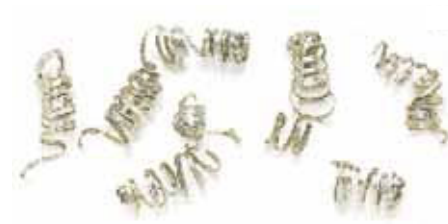
Свободно намотанная (витая) стружка идеальные условия резания
