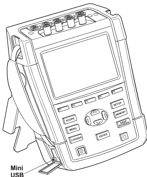
Рис. 4-1. Наклонная подставка и расположение USB-разъема
